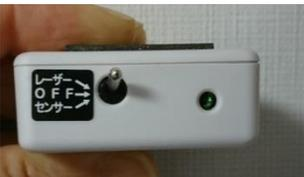
スイッチレバーを“レーザー”位置に倒し、センサー部分から赤色レーザー光の照射を確認します。
