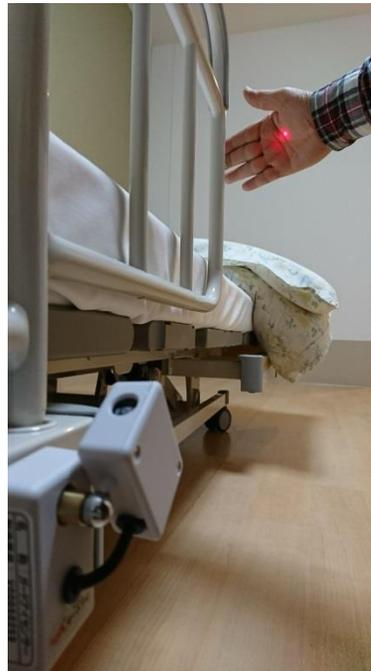
レーザーで検知位置を手のひらで確認
