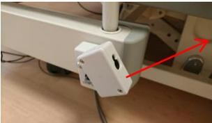
ガードアイセンサー部分をベッドにマグネットに取り付けます。センサーを上下左右に動かし、検知したい箇所周辺に手のひらへ赤色レーザーを照射させます。
