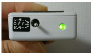
スイッチレバーを“センサー”に倒します。その際に、ミドリ色のランプが点灯します。
